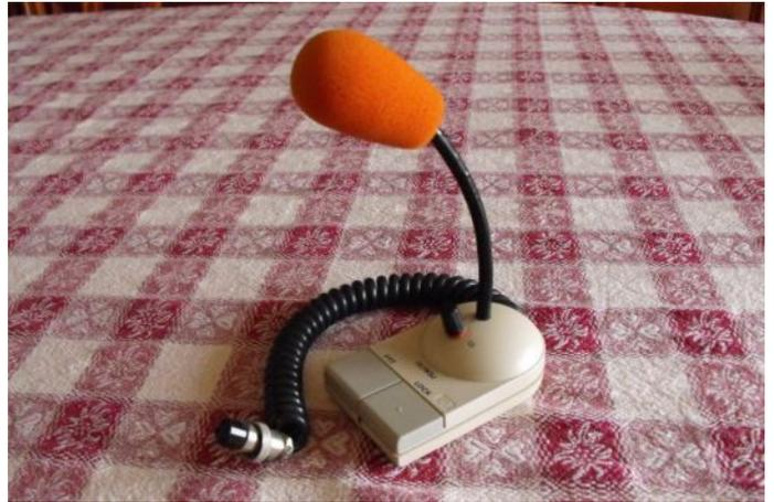
**Primo prototipo di microfono preamplificato con ptt e lock e come base un vecchio mouse della HP**
