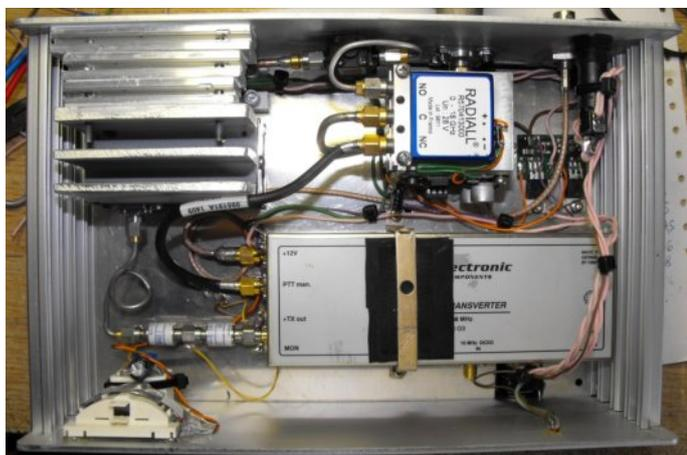
*Il transverter 10Ghz ssb assemblato e collaudato*
