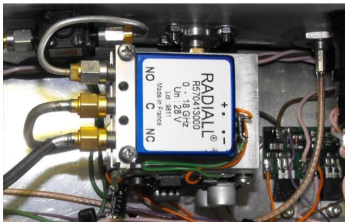
*Il sequencer, il relè coassiale e il survolatore di tensione 12-28V per la commutazione tx-rx incluso il finale da 1W*
